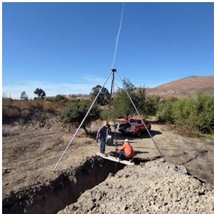
Vista panorámica de pruebas de penetración estándar SPT 3
